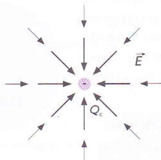
..... Figura 13: Campo eléctrico em vários pontos de um campo criado por uma carga eléctrica pontual negativa.
