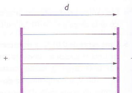
..... Figura 27: Num condensador de placas planas paralelas, podemos calcular a intensidade do campo eléctrico à custa da variação do potencial eléctrico e da distância entre as placas  $E = \frac{V}{d}$ .
