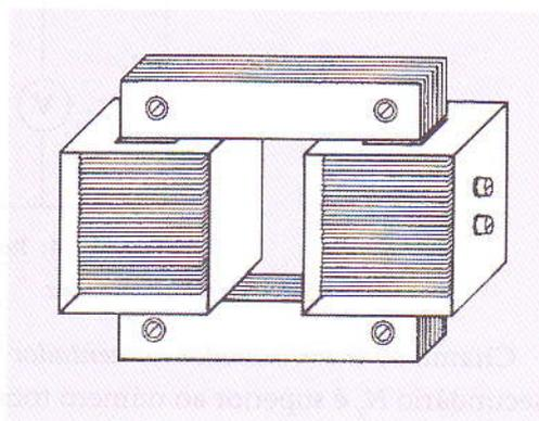
..... Figura 62: Desenho esquemático de um transformador com um enrolamento primário e secundário num núcleo de aço.
