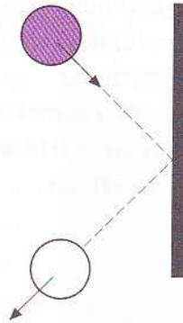
..... Figura 37: A mudança da direcção da velocidade e do momento linear depois da colisão dum a bola de *snooker* com a tabela.
