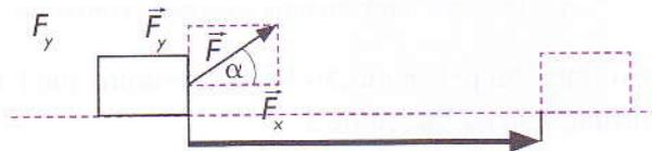
..... Figura 11: Uma componente da força oblíqua aplicada pode realizar-se na direcção do deslocamento.
