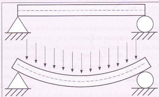
..... Figura 44: A figura mostra o modelo das solicitações (cargas) a que está sujeita uma ponte. A carga é exercida sobre a viga principal.
