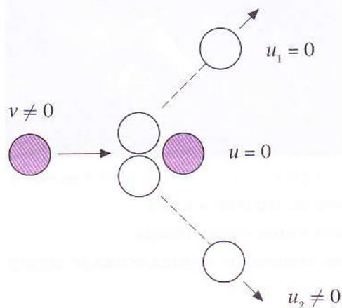
..... Figura 39: Colisão de um berlimde com dois berlindes inicialmente em repouso. Depois da colisão, os dois berlindes movem-se com velocidade  $v_1$  e  $v_2$  em diferentes direcções. O impulso, e assim o momento linear, transmite-se parcialmente para cada um dos berlindes.
