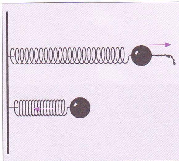
..... Figura 5: Mola esticada e mola comprimida. A energia total do sistema mantém-se constante.
