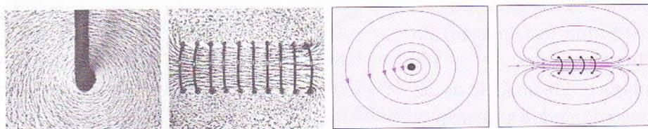
..... Figura 38: Espectros magnéticos produzidos por uma corrente rectilínea e por uma corrente helicoidal (corrente de uma bobina com várias espiras.)
