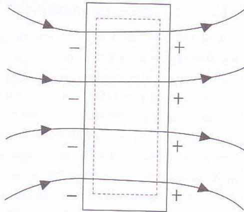
..... Figura 29: Os portadores de carga redistribuem-se devido à acção do campo eléctrico.
