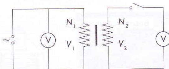
..... Figura 64: Representação esquemática de um transformador.
