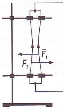
..... Figura 45: Força de Lorentz entre condutores de corrente eléctrica rectilínea.
