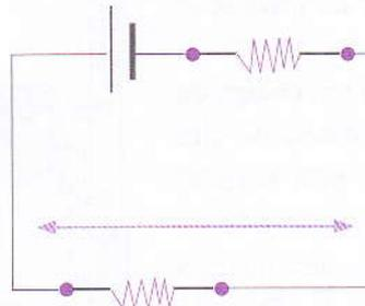
..... Figura 16: Numa bateria real a diferença entre os terminais, a chamada *voltagem da bateria*, não é igual à da fonte da f.e.m. Isso deve-se ao facto de qualquer bateria estar associada a uma resistência interna.
