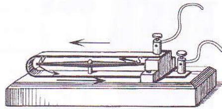
..... Figura 33: Multiplicador de Schweigger. Composto por um condutor curvado na forma de U, no interior do qual foi colocada uma agulha magnética.
