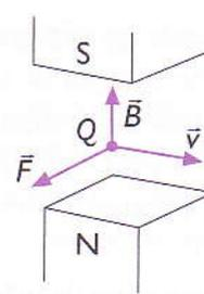
..... Figura 46: Uma carga eléctrica em movimento num campo magnético permanente produzido por ímanes.
