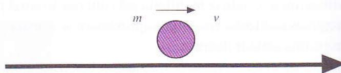
..... Figura 35: Uma bola de massa movendo-se com uma dada velocidade possui uma quantidade de movimento ou um momento linear.
