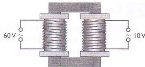
..... Figura 57: Indução electromagnética por variação do campo magnético. Princípio do funcionamento do transformador.
