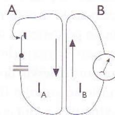
..... Figura 47: Dois circuitos muito próximos um do outro. Pode a corrente do primeiro circuito produzir corrente eléctrica no segundo circuito?
