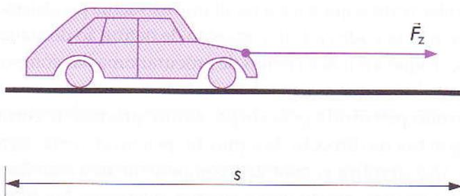
..... Figura 9: Trabalho de aceleração devido a uma força constante que imprime também uma aceleração constante.
