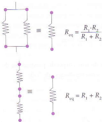
..... Figura 10: Circuitos eléctricos complexos podem ser reduzidos a circuitos mais simples aplicando as regras de adição das resistências em série e em paralelo.
