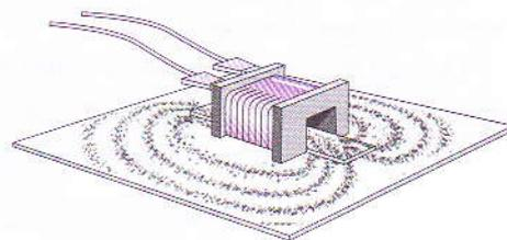
..... Figura 36: Espectro magnético de uma bobina percorrida pela corrente eléctrica.
