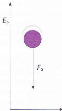
..... Figura 26: O trabalho realizado é armazenado na forma de energia potencial gravítica, que pode ser convertida em movimento de deslocamento vertical para baixo.
