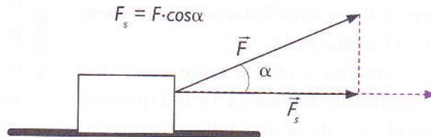
..... Figura 12: O vector resultante da força possui duas componentes. Segundo a regra do paralelogramo, trata-se de uma componente paralela ao deslocamento e outra perpendicular ao deslocamento.
