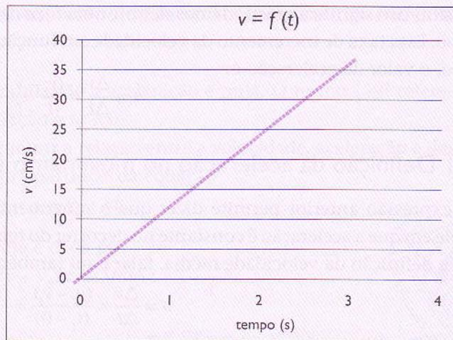
..... Figura 18: Gráfico da velocidade em função do tempo no MRUV.
