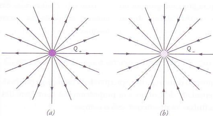
..... Figura 16: As linhas do campo eléctrico de duas cargas pontuais isoladas: a) carga pontual positiva; b) carga pontual negativa.
