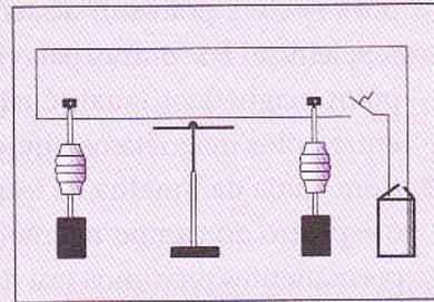
..... Figura 30: A experiência de Oersted consiste num circuito eléctrico simples realizado com fios condutores, uma agulha magnética e uma pilha como f.e.m.
