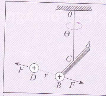
..... Figura 33: Arranjo experimental da balança de torção de Cavendish.
