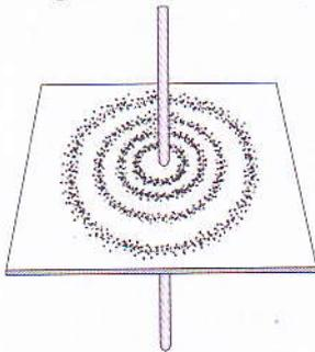
..... Figura 31: O alinhamento da limalha de ferro em torno de um condutor rectilíneo de corrente eléctrica.
