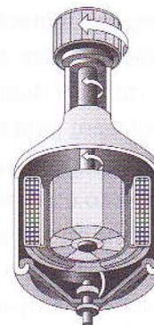
..... Figura 49: Esquema de um dínamo de bicicleta.
