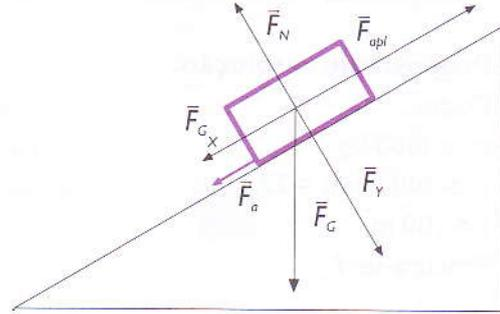
.... Figura 17: Um corpo no plano inclinado está sujeito à força gravitacional resultante. Uma força oblíqua para cima é necessária para levar o corpo a subir o plano inclinado.
