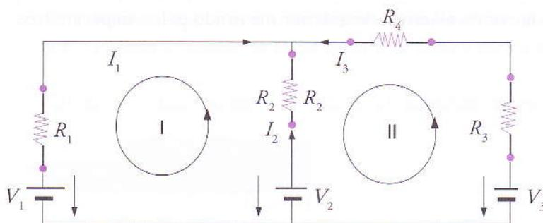
..... Figura 23: Exemplo de uma rede eléctrica constituída por dois circuitos eléctricos de duas malhas.
