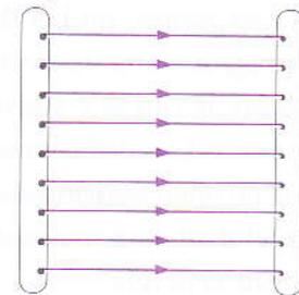
..... Figura 23: Intensidade do campo eléctrico entre as placas paralelas de um condensador.
