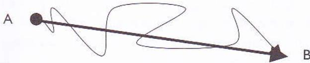
..... Figura 7: O deslocamento caracteriza-se pelo comprimento e sentido do movimento de um ponto material.
