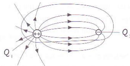
..... Figura 17: Linhas do campo eléctrico para uma configuração de duas cargas eléctricas  $+2 \cdot Q_1$  e  $Q_2$ .
