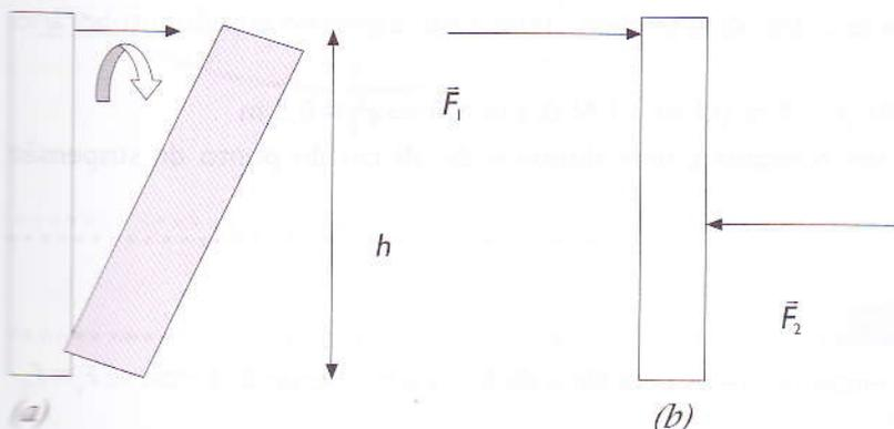
Figura 43: a) O momento de torção devido à acção de uma força impele a peça a entrar em rotação e produz a queda. b) À direita, na imagem, a acção de um binário de forças produz um momento total nulo para manter a peça em repouso. Este é um exemplo claro de que o momento desempenha na rotação  $\Sigma M = 0$  o mesmo papel que a força no movimento rectilíneo, pois, para que a peça esteja em repouso, é necessário que  $\Sigma F = 0$ .
