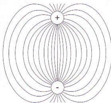
..... Figura 20: Configuração do campo eléctrico de um dipolo eléctrico.
