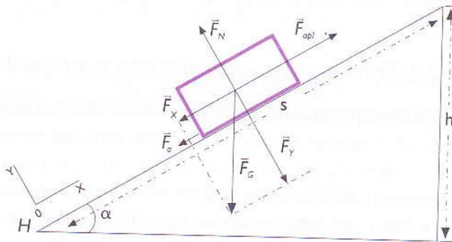
..... Figura 15: Um corpo no plano inclinado está sujeito à força gravitacional resultante. Uma força oblíqua para cima é necessária para mover o corpo a subir o plano inclinado.
