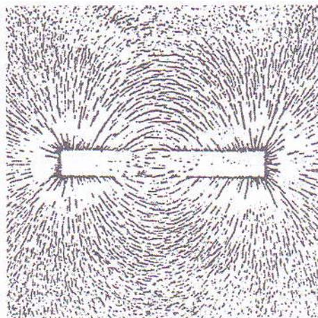
..... Figura 26: O espectro magnético no plano do papel de um íman rectangular é obtido pelo alinhamento dos bocados de limalha de ferro.
