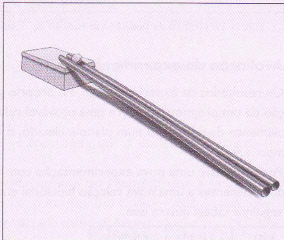
..... Figura 16: Um berlinde ou uma bola de ténis desliza ao longo do trilho de um plano inclinado. Com um cronómetro determina-se em quanto tempo foi percorrido cada intervalo de distância.
