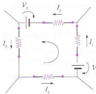
..... Figura 20: A *malha* de uma rede eléctrica.
