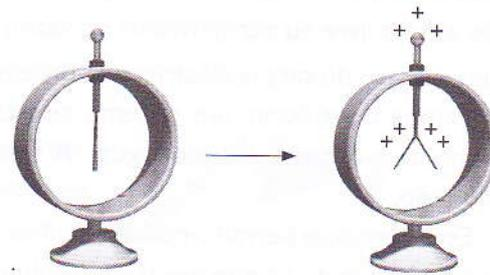
..... Figura 22: Um electroscópio quando sob o efeito da proximidade de um bastão eletrizado mede o efeito da presença de cargas eléctricas ou do campo eléctrico.
