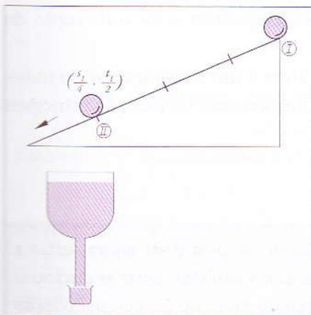
Figura 25: Esboços de Galileu no estudo do MRUV no plano inclinado. A dificuldade de medição do tempo foi superada medindo o tempo que as gotas de água levavam para encher um copo.
