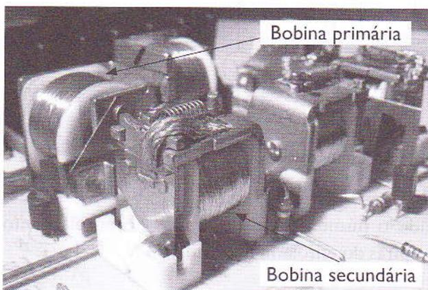
..... Figura 61: Um transformador com dois enrolamentos (bobina primária e bobina secundária).
