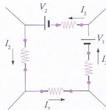
..... Figura 6: Um circuito eléctrico representado esquematicamente por meio de símbolos da resistência eléctrica, fios de ligação e duas fontes de energia eléctrica (f.e.m.).
