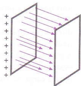
..... Figura 18: Linhas do campo eléctrico entre as placas de um condensador plano.
