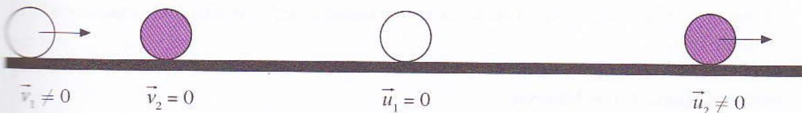
..... Figura 38: Ilustração de uma colisão central e elástica entre dois berlindes. O berlinde sombreado move-se com velocidade  $\vec{u}_2 \neq 0$  depois da colisão enquanto que o berlinde que transmitiu o impulso permanece em repouso depois da colisão. Neste caso, o momento linear transmite-se integralmente para o segundo berlinde.
