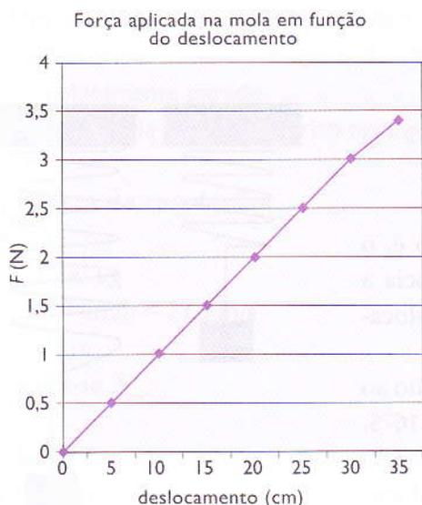
..... Figura 20: Gráfico de  $F \times s$ . Força aplicada na mola em função do deslocamento.
