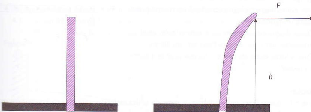
Figura 42: Uma estrutura inicialmente fixa perpendicularmente entre duas vigas, é submetida a uma força aplicada que leva à produção de um momento de torção. A torção da peça deve-se à acção do momento  $M = F \times h$ .
