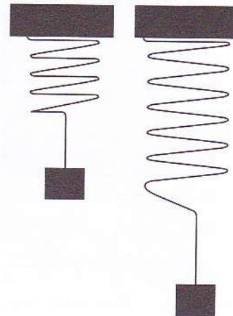
..... Figura 18: O sistema massa-mola está sujeito aos efeitos de uma força restauradora.
