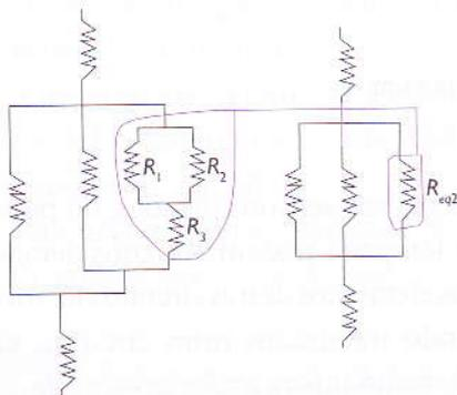
..... Figura 11: Circuitos eléctricos complexos podem ser reduzidos a circuitos mais simples aplicando as regras de adição das resistências em série e em paralelo.
