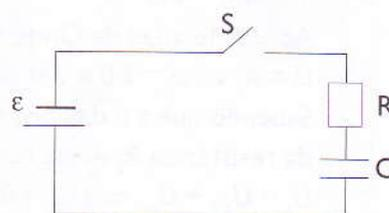
..... Figura 12: Um circuito eléctrico para carregar e descarregar um condensador.
