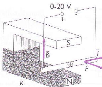
..... Figura 43: Um condutor situado num campo magnético de um íman quando percorrido pela corrente eléctrica experimenta uma força dada pela regra da mão direita.
