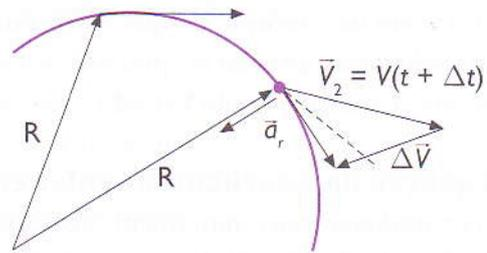
..... Figura 39: Variação em direcção do vector velocidade linear tangente à trajectória circular.
