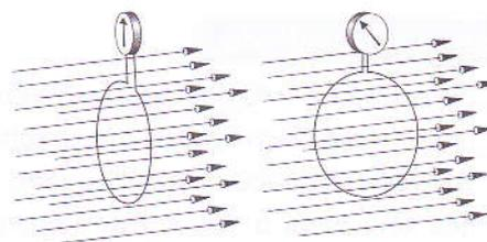
..... Figura 58: Indução electromagnética por variação da configuração do condutor. Princípio de funcionamento do gerador.
