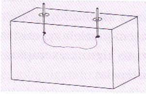
Figura 7: Fio de constantan com os terminais num suporte transparente.
