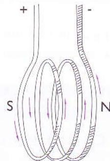
..... Figura 35: Numa bobina dá-se o aumento da intensidade da indução magnética através do aumento do número de espiras quando percorridas pela corrente eléctrica.
