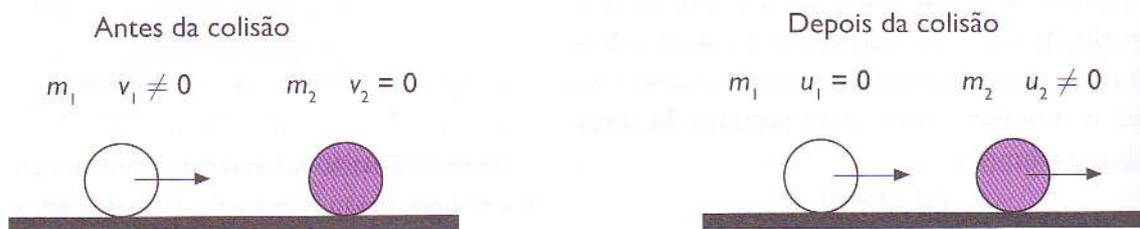
..... Figura 34: A esfera  $m_1$  permanece em repouso depois da colisão e transmite completamente a sua energia cinética e o momento linear à esfera  $m_2$ .
