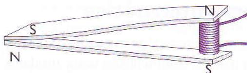
..... Figura 48: Indução electromagnética com barras de ímanes sobre um electroíman ligado a um voltímetro.
