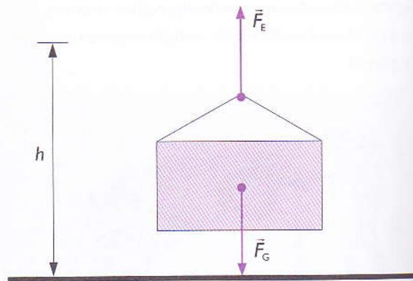
..... Figura 6: Trabalho de deslocamento vertical para cima realizado por uma força aplicada contra a força gravitacional.
