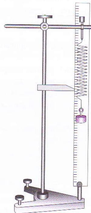
..... Figura 19: Quando se suspende uma massa na mola, a força gravitacional actua contra a força restauradora da mola. A experimentação mostra os resultados do deslocamento em função da força aplicada.
