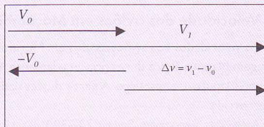
.... Figura 14: Um corpo munido de velocidade  $V_0$  aumenta a sua velocidade para  $V_1$ . A variação da velocidade é representada por um vector dado pela subtracção de vectores  $V_1 - V_0$ . Este vector tem a direcção e o sentido do movimento resultante.
