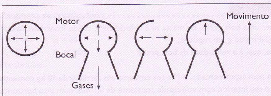
..... Figura 49: Princípio de funcionamento de um motor a propulsão por reacção.
