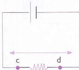
..... Figura 15: Uma bateria ideal é aquela que mantém constante a diferença de potencial entre os seus terminais para qualquer corrente que esteja a circular no circuito.
