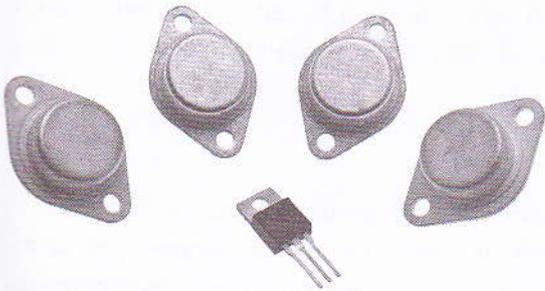
..... Figura 30: Encapsulamento metálico de transístores de alta potência.
