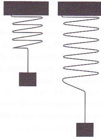
..... Figura 27: Uma mola comprimida à custa do trabalho armazena uma energia potencial. Quando ela se distende realiza trabalho de deslocamento à custa da energia armazenada.
