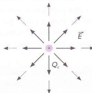
..... Figura 14: Campo eléctrico em vários pontos de um campo criado por uma carga eléctrica pontual positiva.
