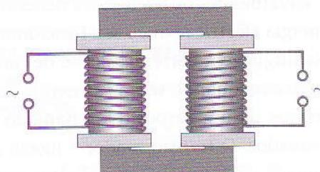
..... Figura 63: O enrolamento primário é alimentado com uma tensão alternada e dá-se a produção de uma tensão induzida ( $V_{11}$ ) no enrolamento primário que gera no enrolamento secundário e regista-se a tensão ( $V_{12}$ ).
