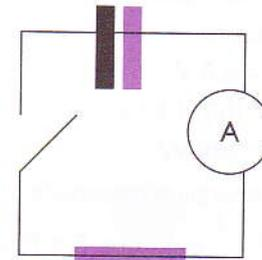
..... Figura 24: Processo de descarga do condensador. Imediatamente depois de se fechar o circuito, as cargas eléctricas negativas movem-se do pólo negativo para outro. Circula uma pequena corrente e a tensão diminui ligeiramente.
