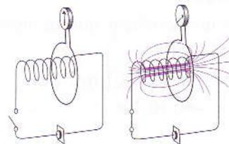
..... Figura 54: Situação referida no ponto 12 em que o campo magnético é criado pela bobina percorrida pela corrente eléctrica.
