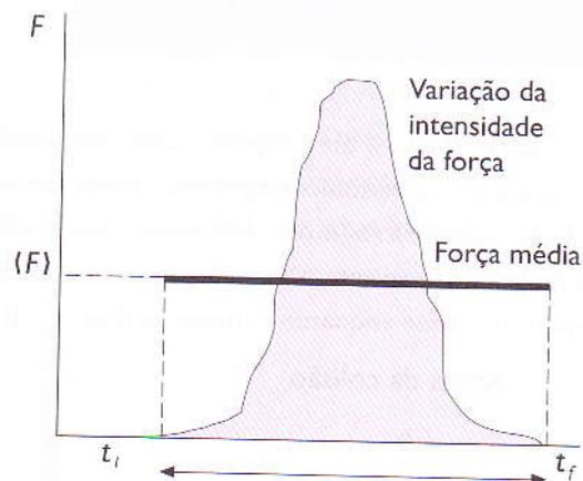
..... Figura 31: Variação da força em função do tempo durante uma colisão. A área sob a curva do gráfico é o valor do impulso.
