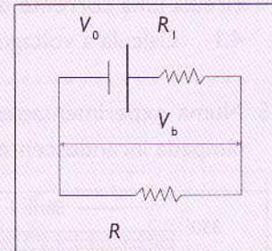
..... Figura 24: Circuito eléctrico de uma bateria real.
