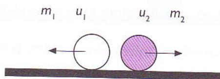
..... Figura 32: Dois berlines de massas iguais e velocidades iguais que se chocam centralmente: a) antes da colisão e b) depois da colisão.
