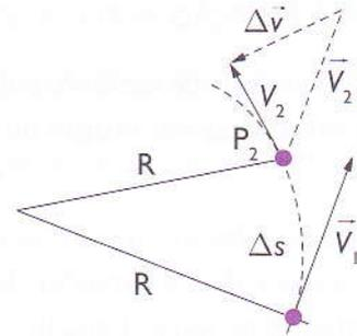
..... Figura 38: Representação geométrica da variação dos vectores de velocidade, mostra que  $\Delta v$  aponta na direcção do centro da trajectória circular.
