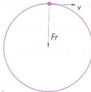
..... Figura 14: No movimento circular, o trabalho realizado por uma força radial perpendicular ao deslocamento do ponto material, é nulo.
