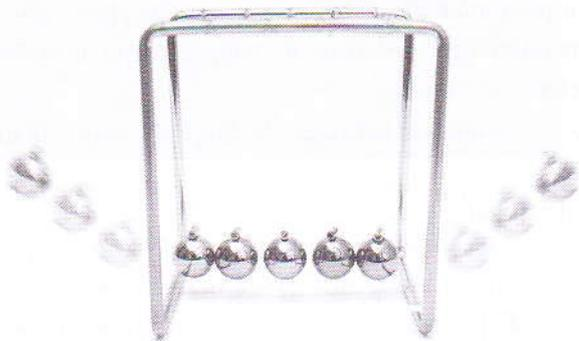
..... Figura 33: Esta é uma experiência de colisão usando cinco esferas ou berlindes suspensos. Quando se eleva e se larga o primeiro berlinde, este colide com o segundo berlinde. Curiosamente, o berlinde permanece em repouso depois da colisão enquanto o último berlinde se solta.
