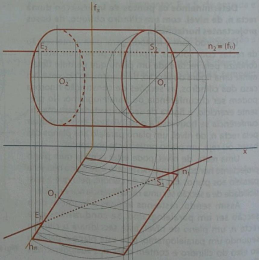
Fig. 48 Determinação dos pontos **E** e **S** procurados.
