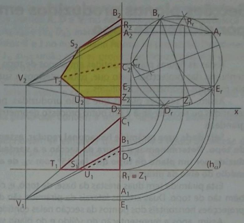
Fig. 13 Secção produzida numa pirâmide pentagonal por um plano de frente.
