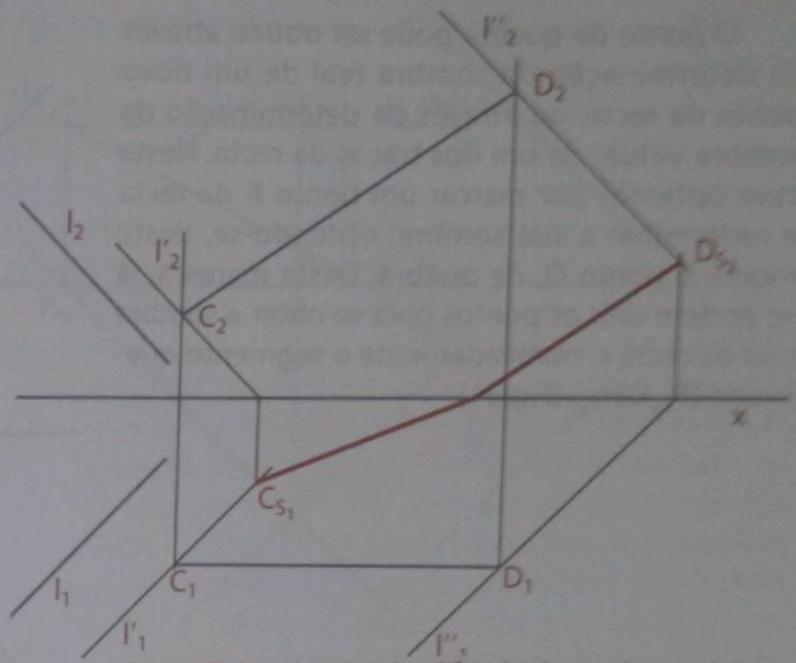
Fig. 30 Determinação simplificada da sombra real do segmento  $[CD]$ .
