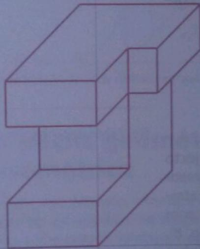
Fig. 5 Peça geométrica representada em perspectiva cavaleira.
