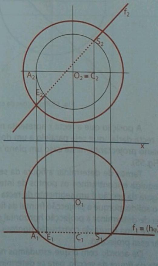
Fig. 54 Determinação dos pontos  $E$  e  $S$
