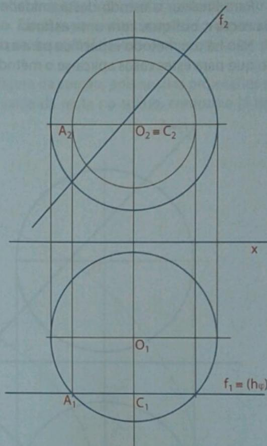
A projecção horizontal da circunferência da secção está reduzida a um segmento de recta que se situa sobre a projecção horizontal da recta  $f$  que coincide com o traço horizontal do plano auxiliar de frente,  $f_1 \equiv (h_\varphi)$ . Portanto, para descobirmos os pontos de intersecção da recta com a figura da secção, temos de recorrer à projecção frontal da recta e da figura da secção, pois é nessa projecção onde a sua intersecção se visualiza claramente.
