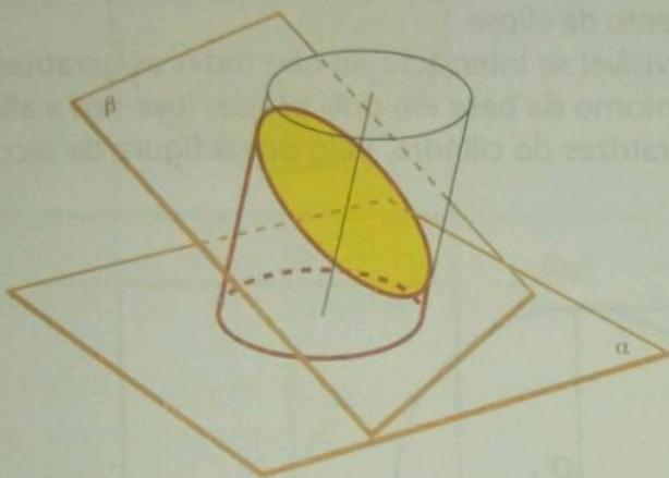
Fig. 66 A figura de secção é uma elipse.
