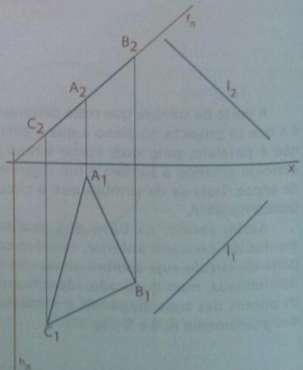
Fig. 59 Projecções do triângulo e do raio luminoso I.
