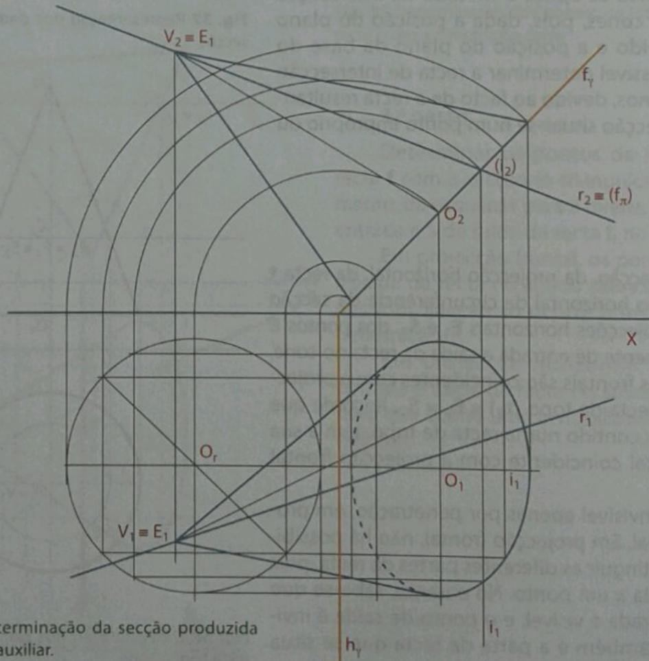
**Fig. 39** Determinação da secção produzida pelo plano auxiliar.
