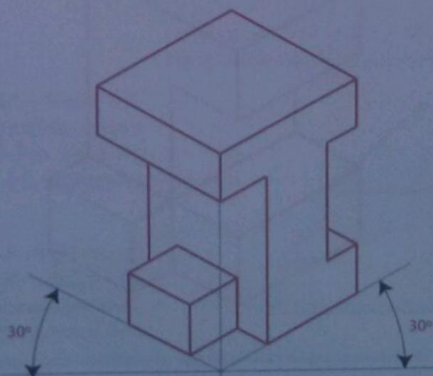
Fig. 13 Forma geométrica representada em axonometria isométrica.
