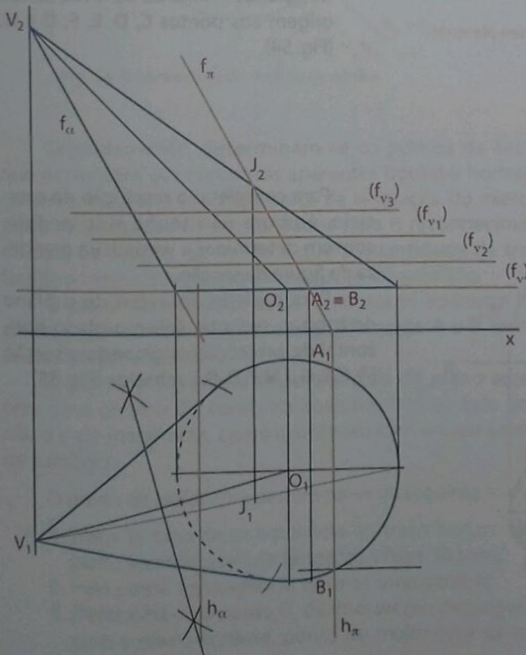
Fig. 53 Utilização do método de planos paralelos à base
