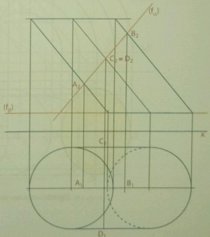
Fig. 79 Projecções de mais dois pontos da figura da secção
