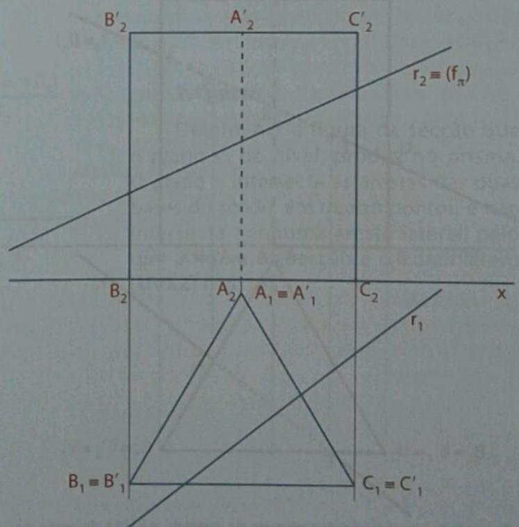
Fig. 12 Representação do plano auxiliar
