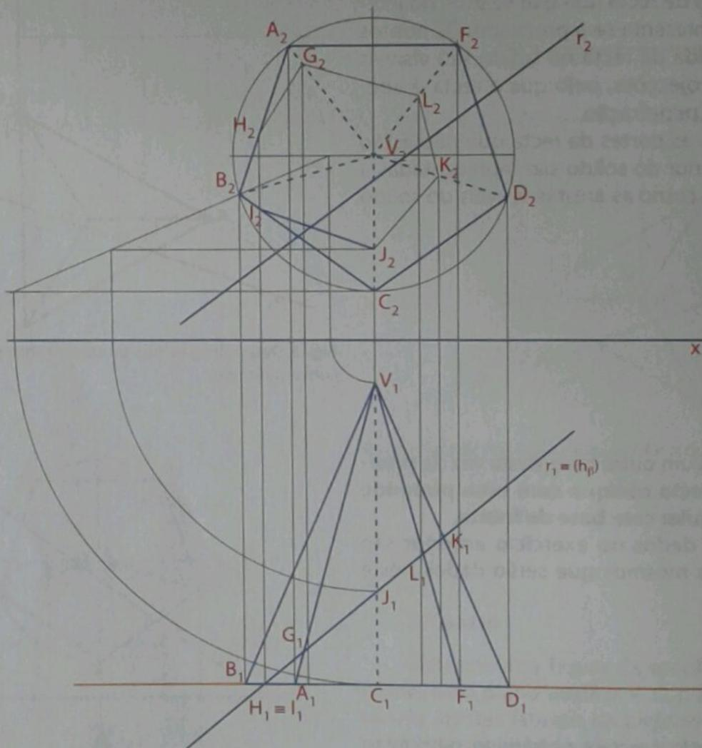
Fig. 7 Determinação da secção produzida pelo plano auxiliar  $\beta$ .
