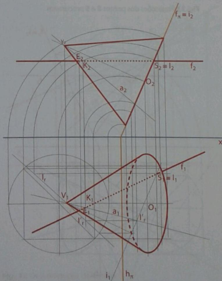
Fig. 36 Determinação dos pontos  $E$  e  $S$  procurados.
