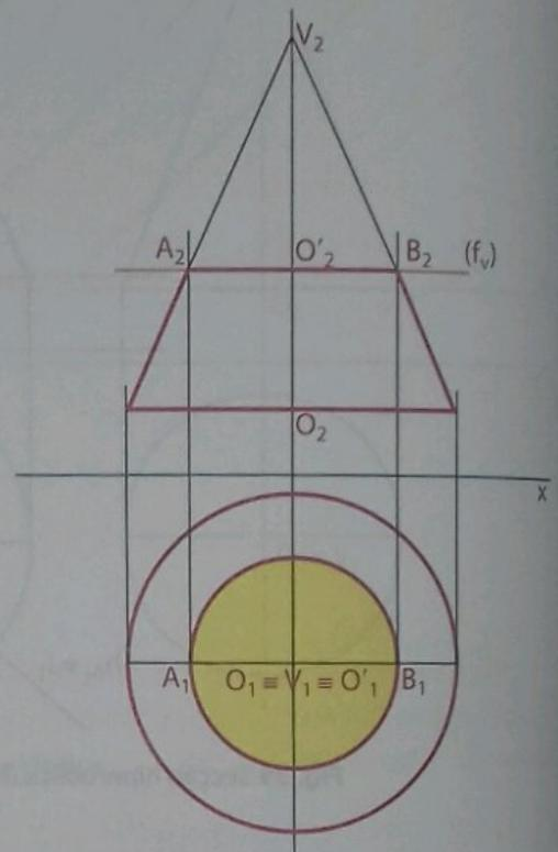
Fig. 40 Secção produzida num cone de revolução de base de nível por um plano de nível.
