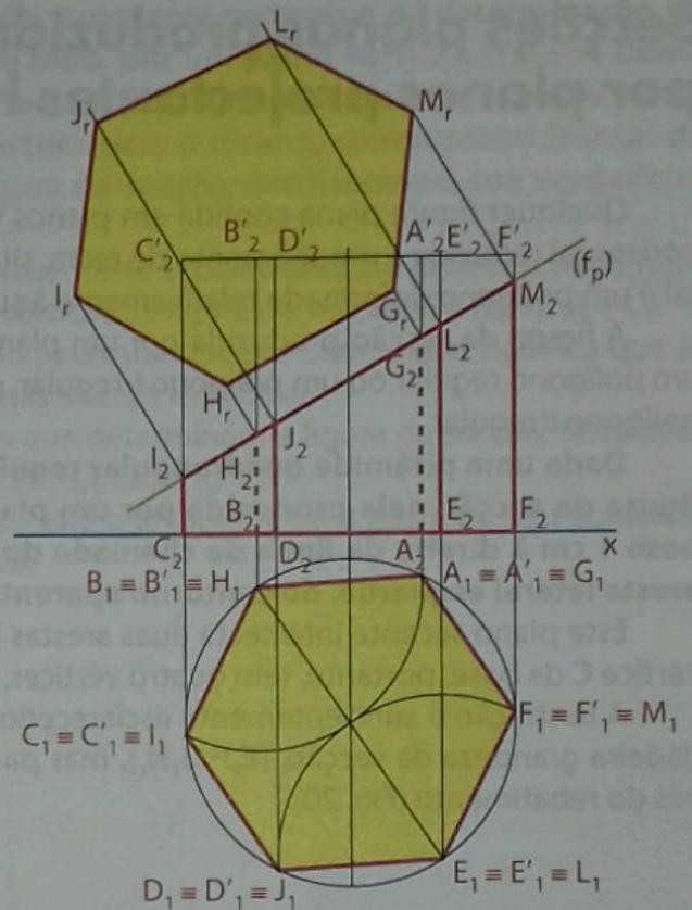
Fig. 18 Secção produzida num prisma hexagonal por um plano de topo.
