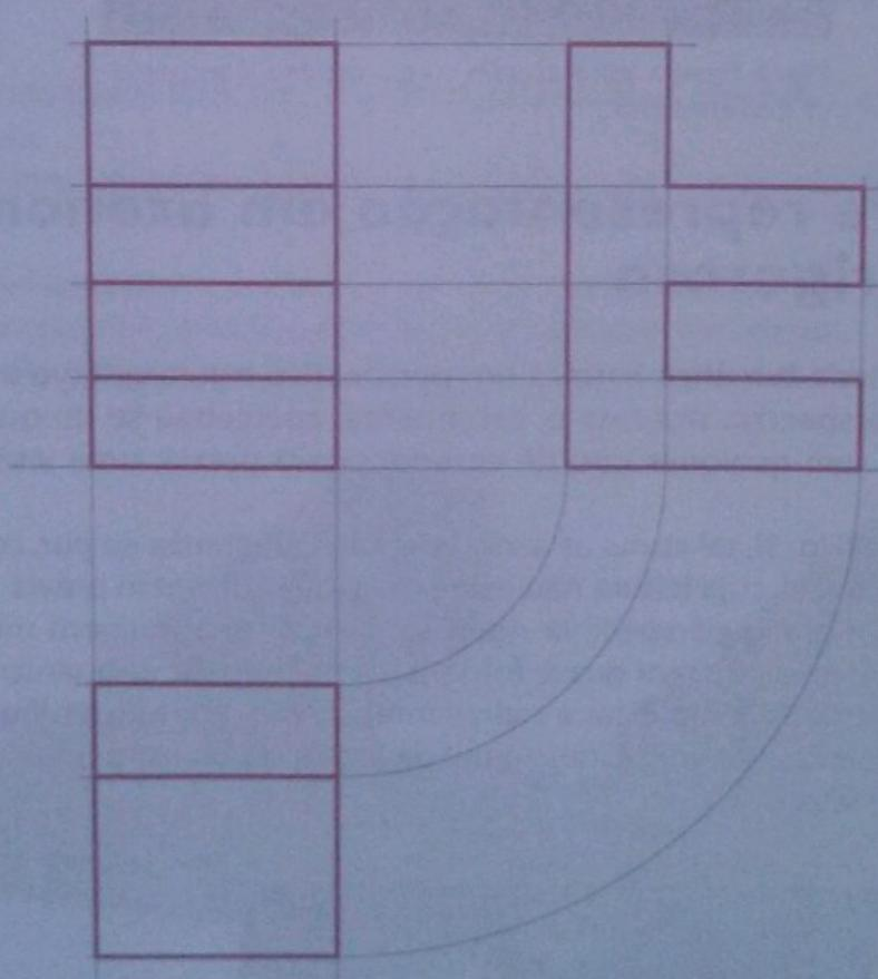
Fig. 4 Projecções ortogonais dum peça geométrica
