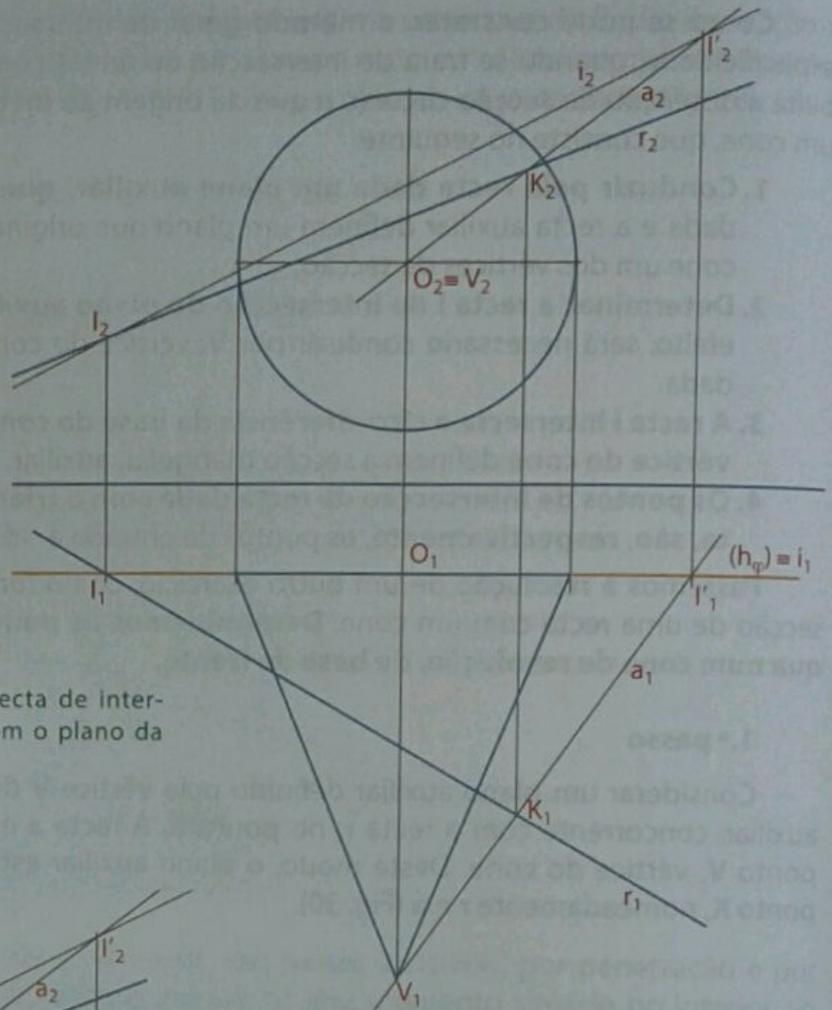
**Fig. 31** Determinação da recta de intersecção do plano auxiliar com o plano da base do cone.
