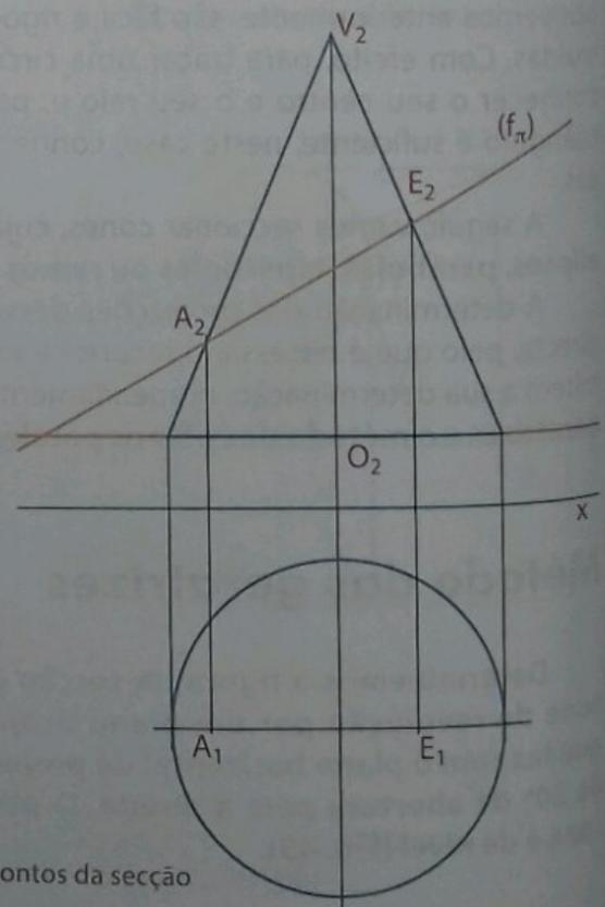
Fig. 45 Projecções de dois pontos da secção
