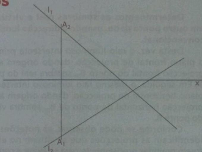
Fig. 12 Projecções do ponto  $A$  e do raio luminoso  $I$
