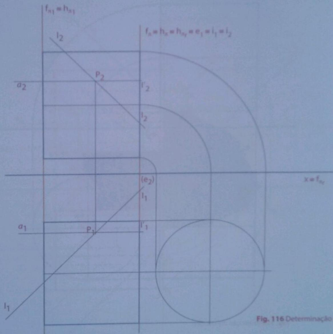
Fig. 116 Determinação da recta **i**
