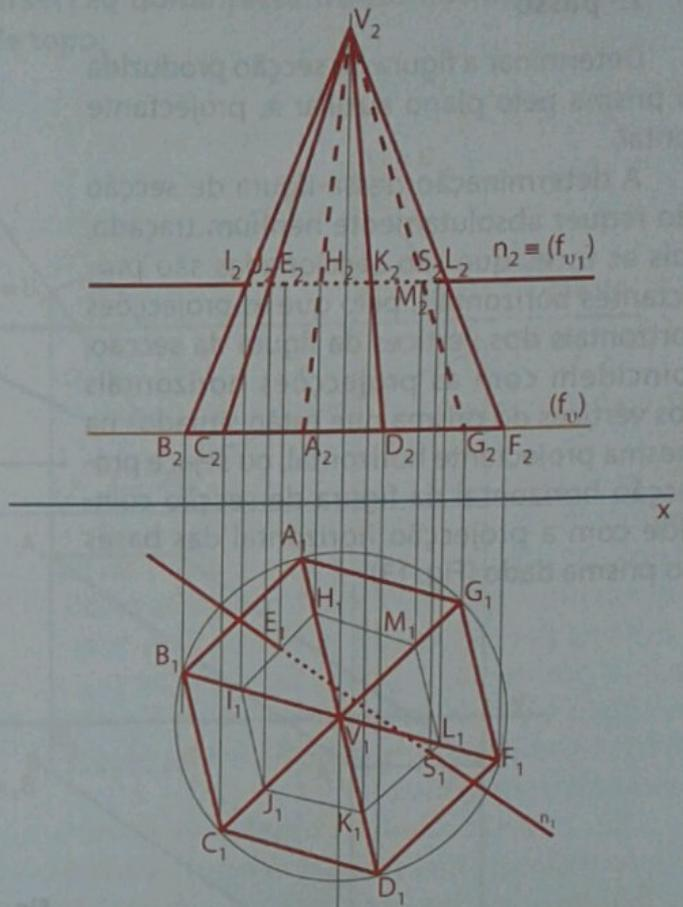
Fig. 11 Determinação dos pontos E e S
