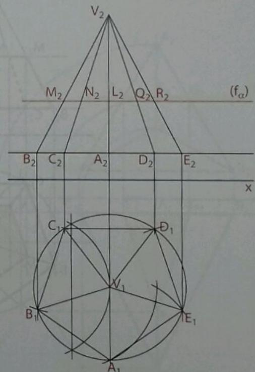
Fig. 5 Projecções da pirâmide, representação do plano secante e projecções frontais dos vértices da figura da secção
