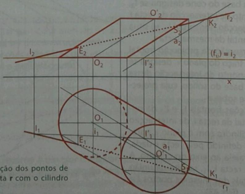
Fig. 45 Determinação dos pontos de intersecção da recta  $r$  com o cilindro oblíquo
