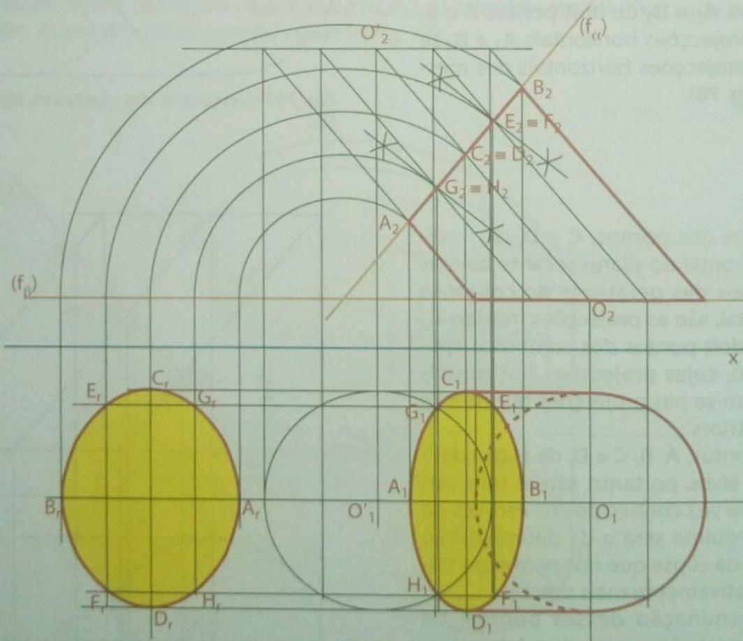
Fig. 80 Secção no cilindro e sua V. G.
