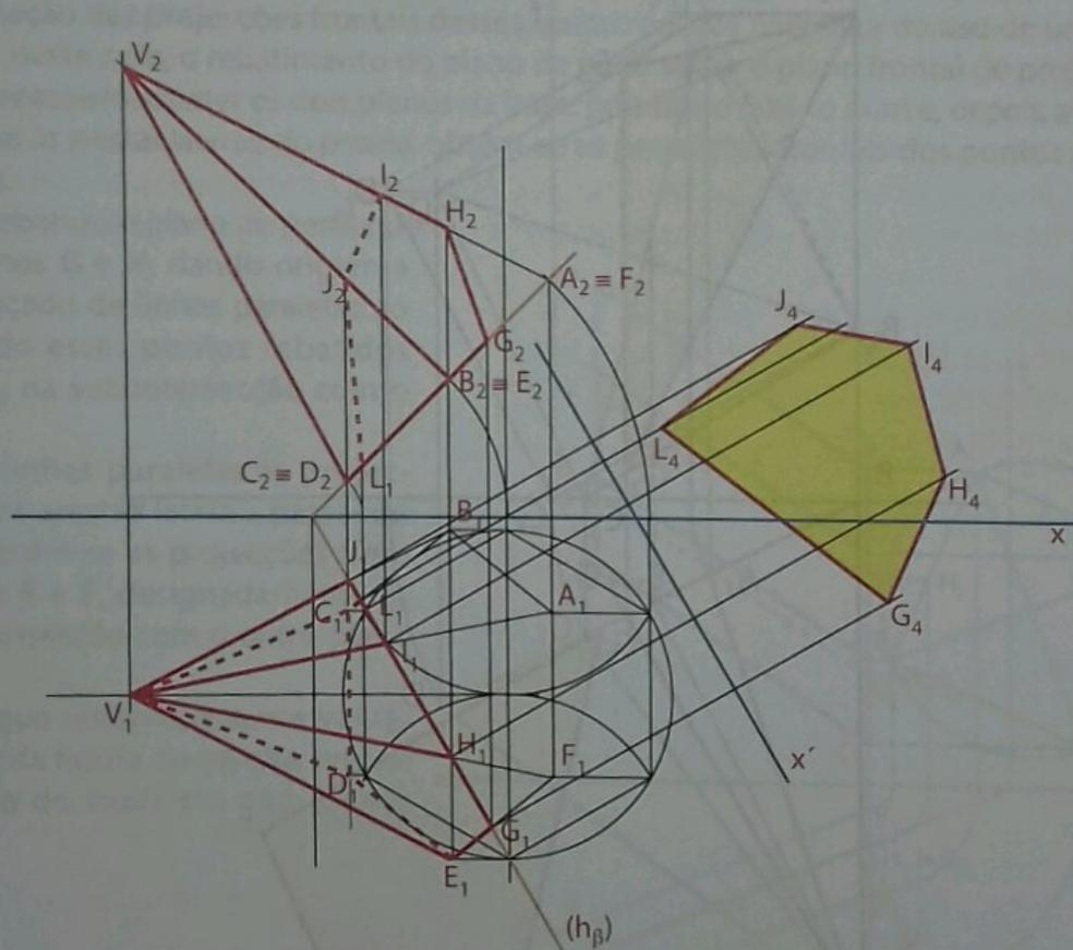
Fig. 21 Secção produzida numa pirâmide por um plano vertical.
