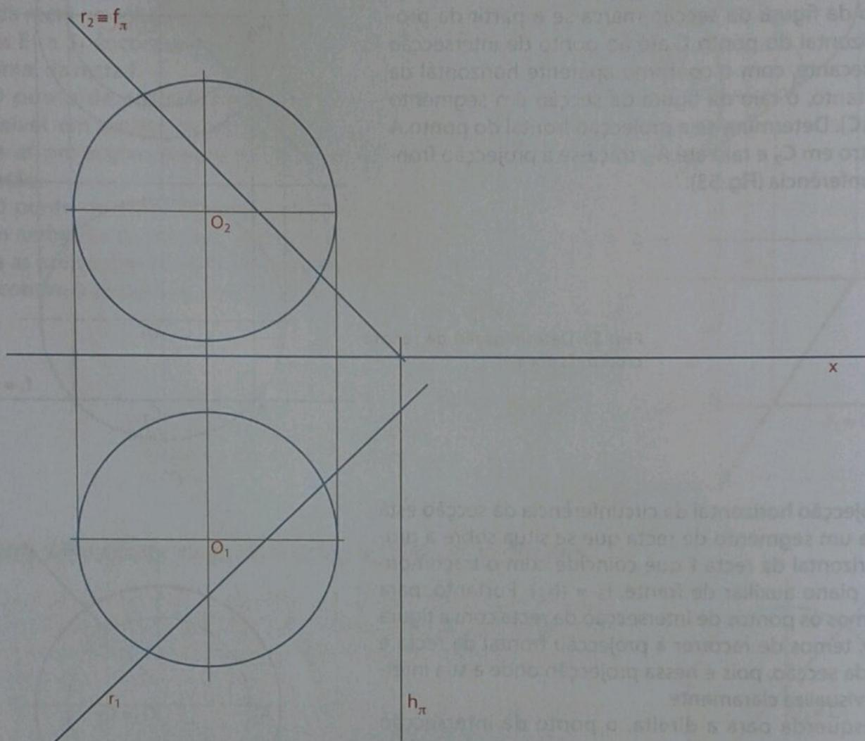
**Fig. 55** Projecções da esfera, da recta e representação do plano auxiliar
