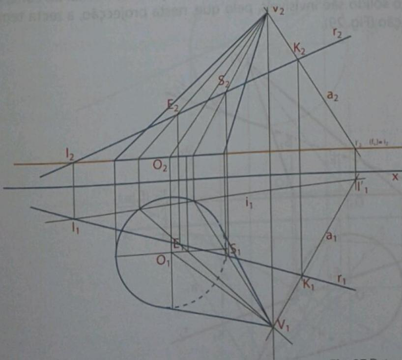
Fig. 27 Determinação dos pontos **E** e **S** procurados.
