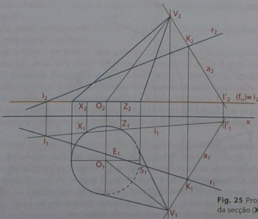
**Fig. 25** Projecções de dois pontos da secção ( $X$  e  $Z$ )
