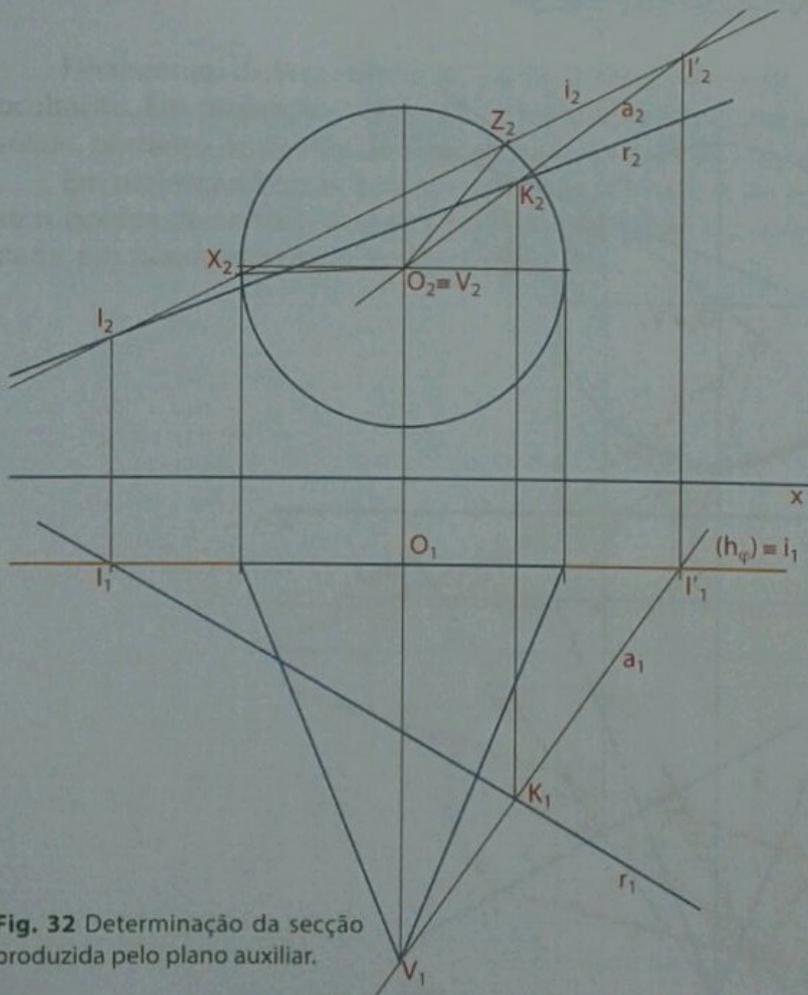
**Fig. 32** Determinação da secção produzida pelo plano auxiliar.
