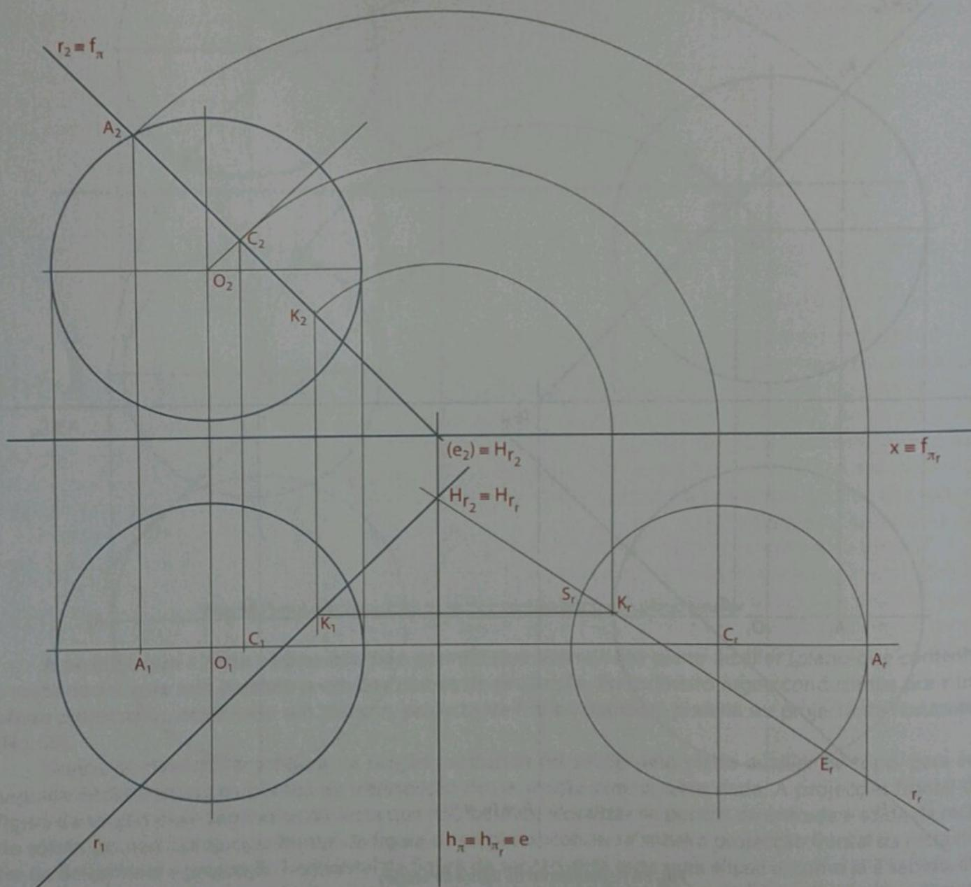
Fig. 57 Determinação dos pontos de entrada e saída, na secção rebatida.
