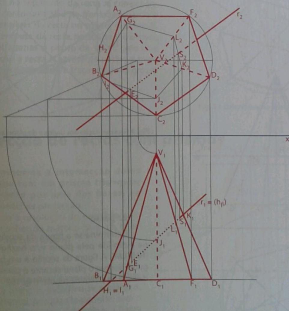
Fig. 8 Projecções dos pontos de entrada e saída da recta  $r$  no sólido
