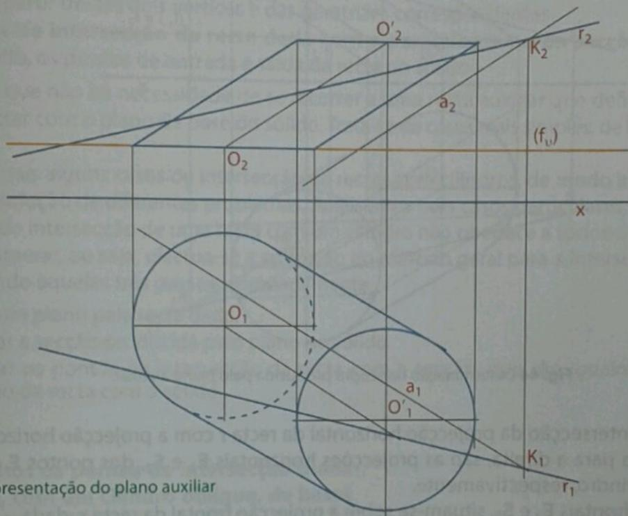
Fig. 42 Representação do plano auxiliar
