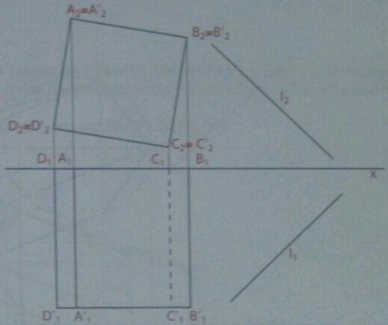
Fig. 91 Projeções do prisma e de  $l$
