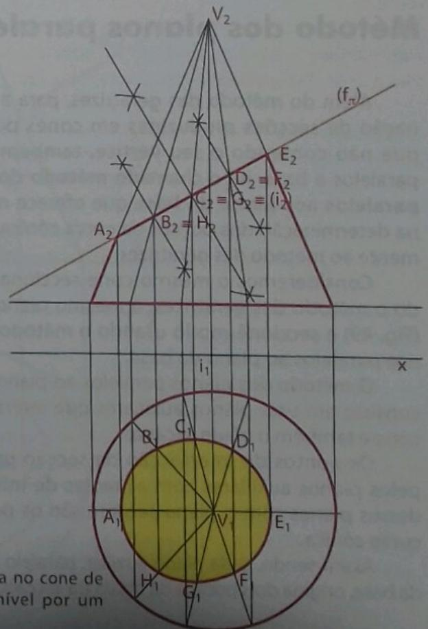
Fig. 47 Secção produzida no cone de revolução de base de nível por um plano de topo.
