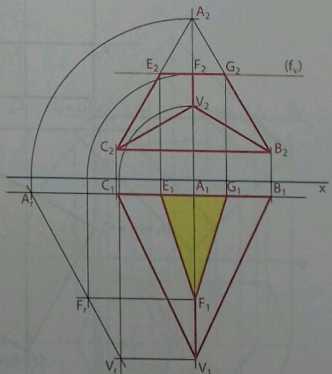
Fig. 8 Secção produzida numa pirâmide triangular por um plano de nível.
