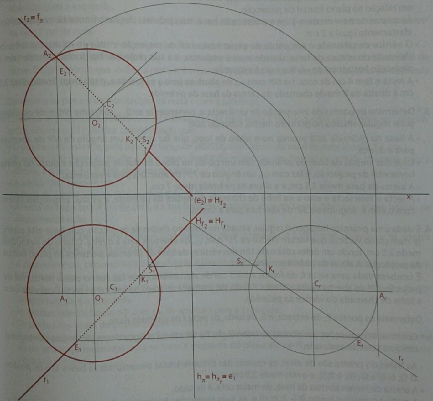
Fig. 58 Projecções dos pontos de intersecção da recta r com a esfera
