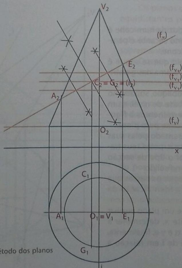
Fig. 50 Utilização do método dos planos paralelos à base
