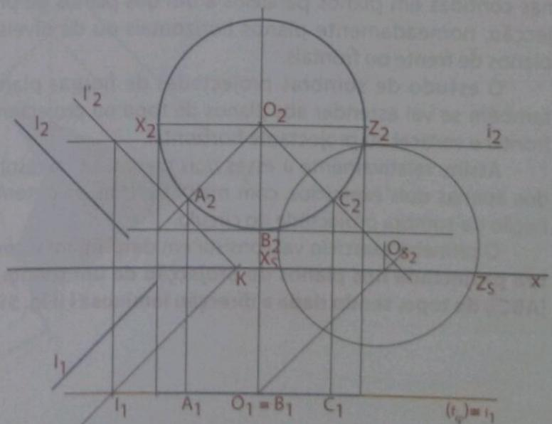
Fig. 57 Projeções dos pontos A, B e C
