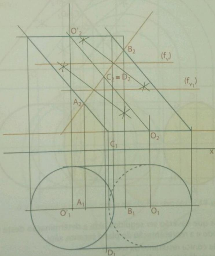
Fig. 81 Representação dos planos auxiliares paralelos aos planos das bases
