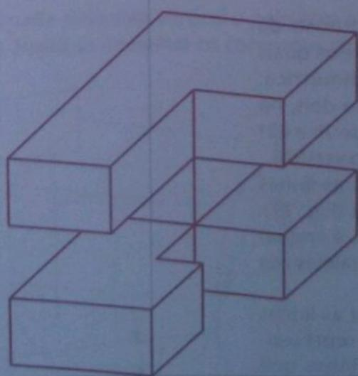
Fig. 15 Forma geométrica representada em axonometria dimétrica.
