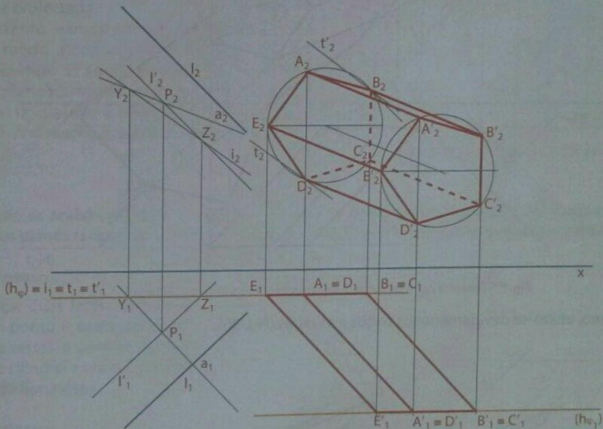
Fig. 94 Determinação das tangentes  $t$  e  $t'$
