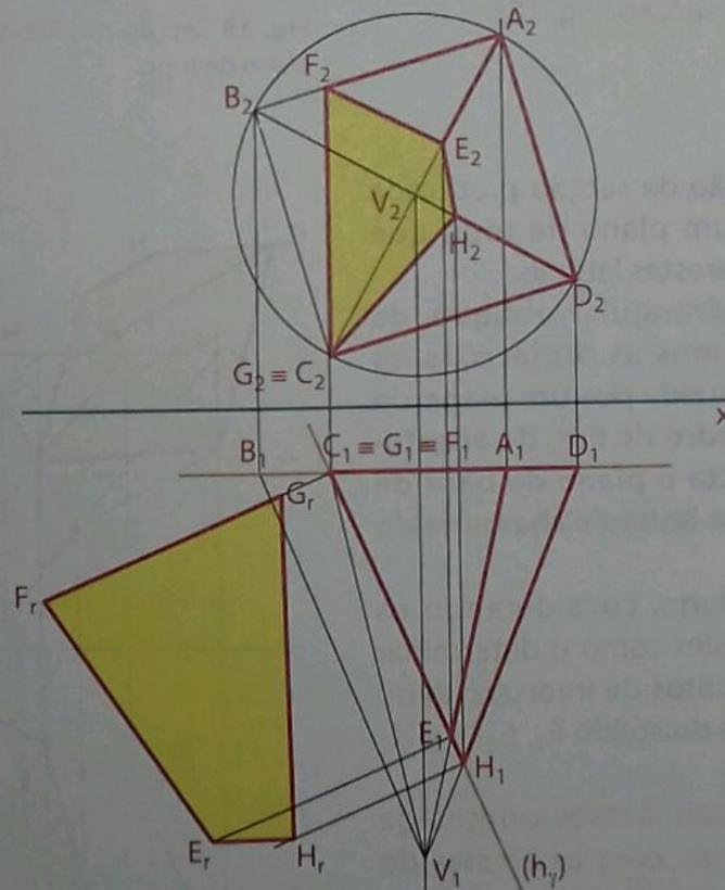
Fig. 20 Secção produzida numa pirâmide quadrangular por um plano vertical.
