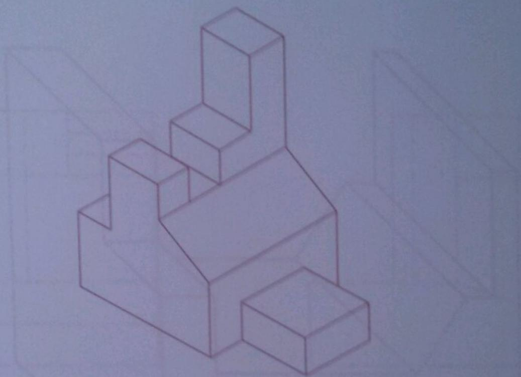
4. Represente a peça em axonometria isométrica.
