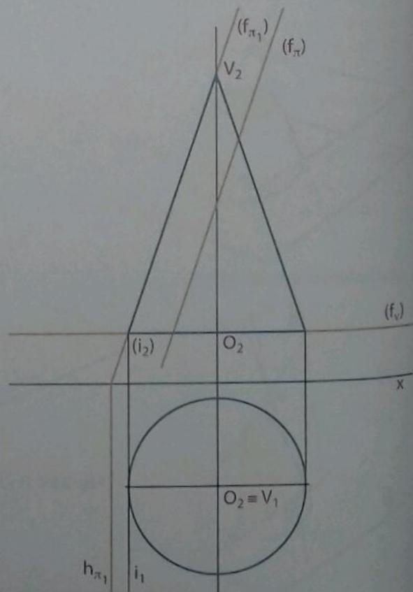
Fig. 38 Secção parabólica
