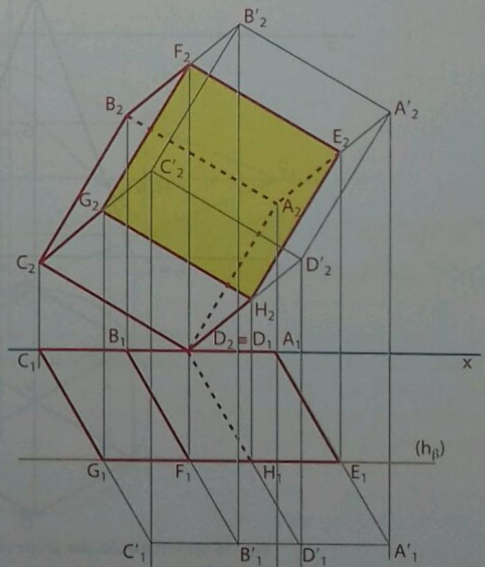
Fig. 14 Secção produzida num prisma por um plano de frente.
