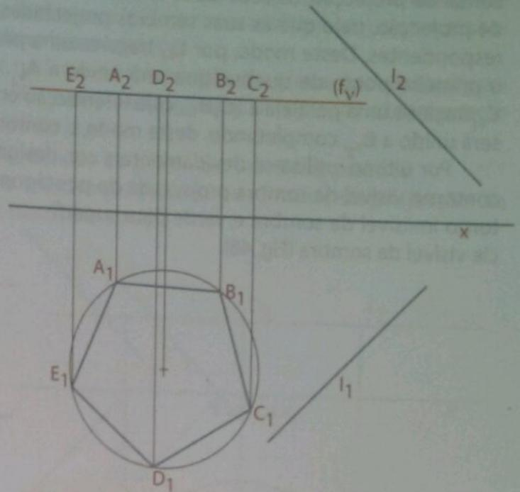
Fig. 44 Projeções do pentágono e da direcção luminosa
