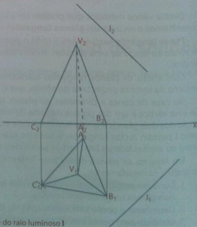
Fig. 73 Projecções da pirâmide e do raio luminoso  $l$
