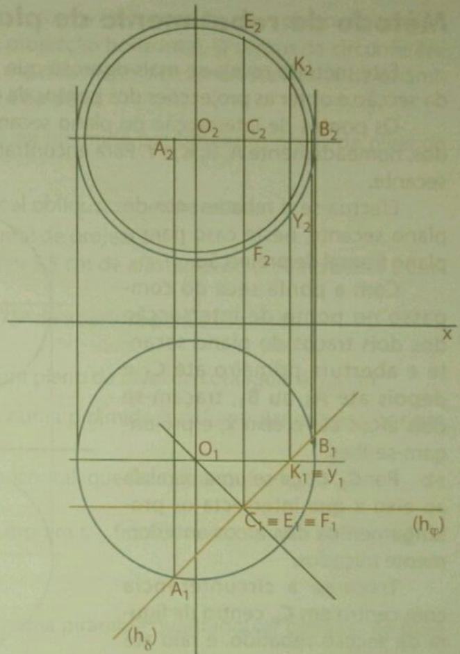
Fig. 88 Projecções de mais pontos da figura da secção
