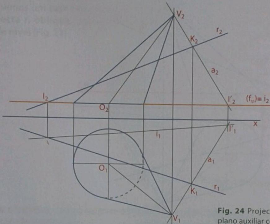
**Fig. 24** Projecções da recta de intersecção do plano auxiliar com o plano da base
