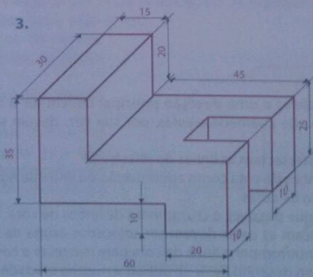
Fig. 25 Forma desenhada em axometria e cotada.
