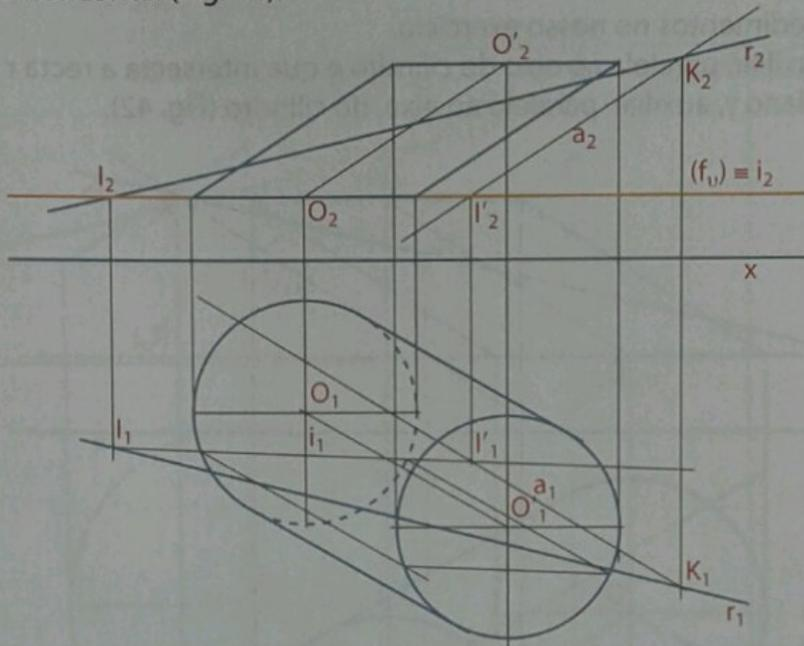
Fig. 44 Determinação da secção produzida pelo plano auxiliar.
