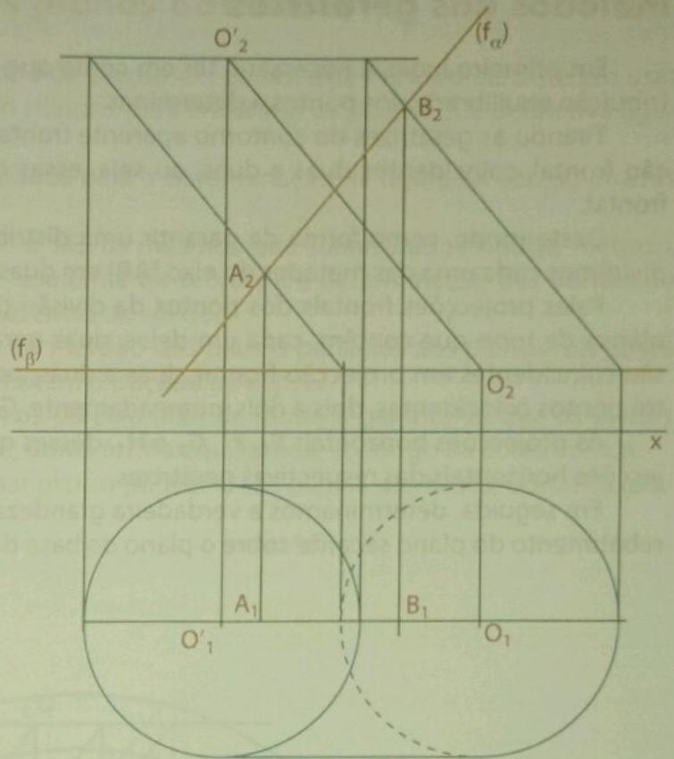
Fig. 78 Projecções de dois pontos da figura de secção
