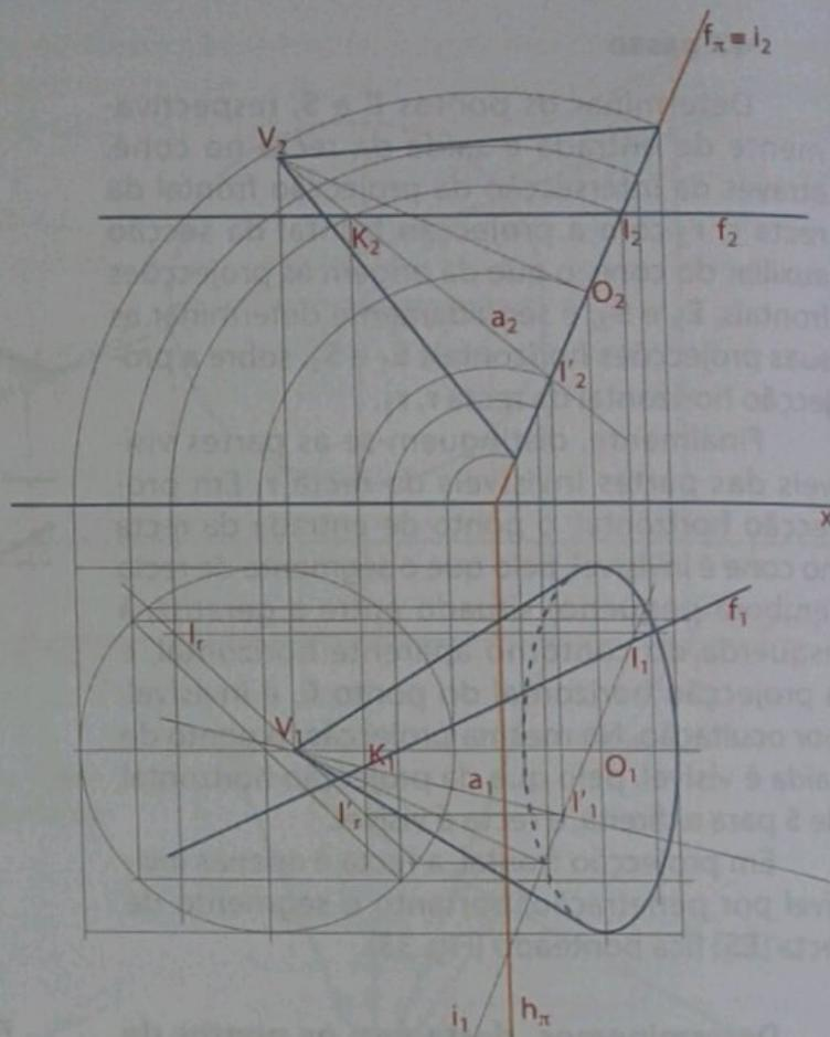
Fig. 35 Determinação dos pontos de intersecção da recta  $i$  com a directriz do cone
