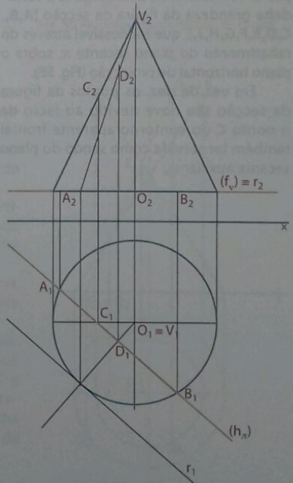
Fig. 57 Projecções de quatro pontos da figura de secção
