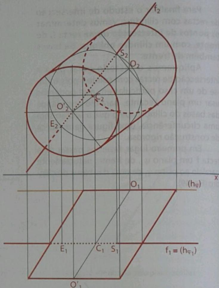
Fig. 51 Determinação dos pontos de intersecção de  $f$  com o cilindro oblíquo
