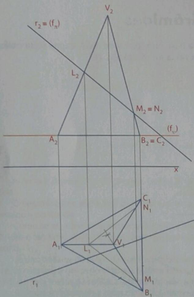
Fig. 4 Determinação da secção produzida pelo  $\pi$ .
