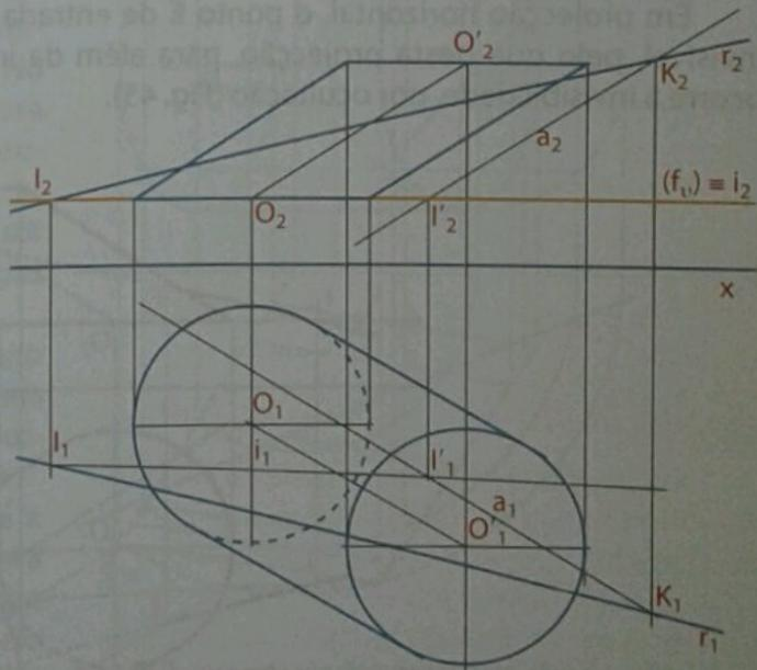
Fig. 43 Determinação da recta de intersecção do plano auxiliar com o plano da base
