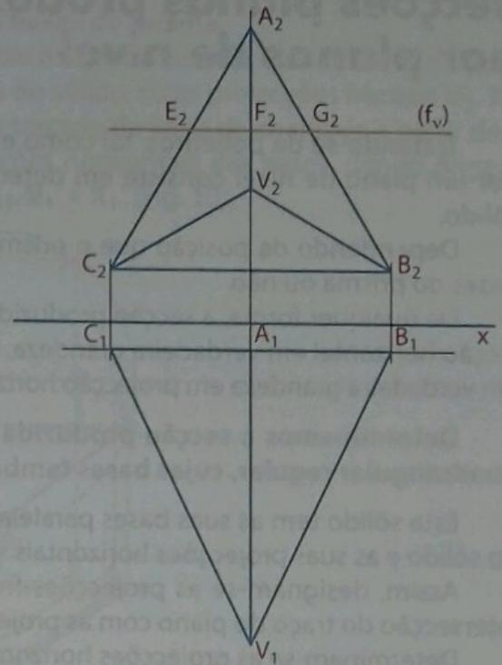
Fig. 7 Projecções da pirâmide, representação do plano secante e projecções frontais dos vértices da figura da secção
