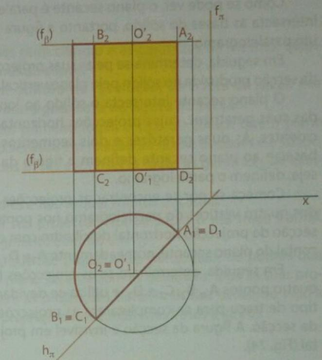
Fig. 72 Secção produzida por um plano paralelo ao eixo.
