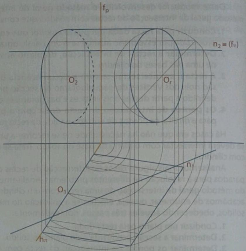
Fig. 47 Determinação da secção produzida pelo plano auxiliar.
