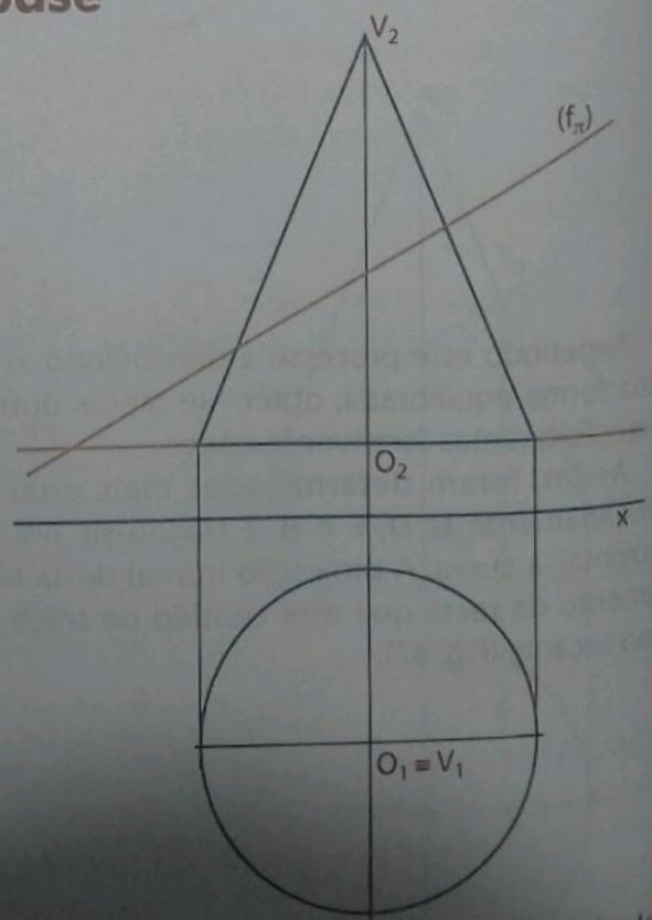
Fig. 49 Projecções do cone e representação do plano secante
