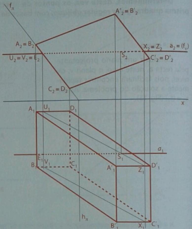
Fig. 17 Determinação dos pontos de intersecção da recta com o prisma
