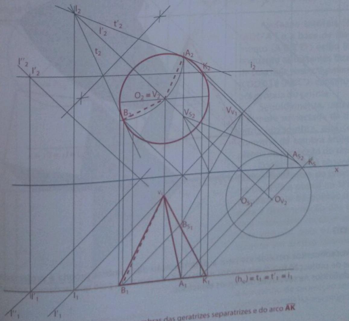
Fig. 89 Determinação das sombras das geratrizes separatrizes e do arco  $\overline{AK}$
