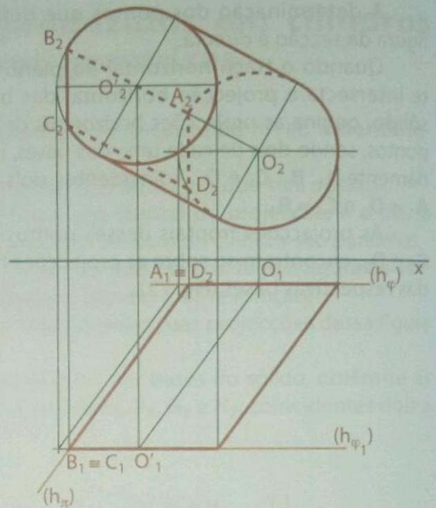
Fig. 74 Projeções da figura da secção
