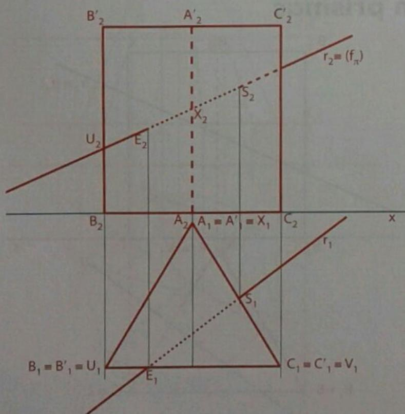
Fig. 14 Determinação dos pontos de entrada e saída da recta no sólido
