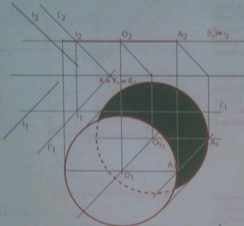
Fig. 50 Sombra projectada do círculo paralelo a  $v_0$ .
