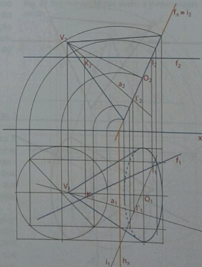
Fig. 34 Determinação da recta  $i$  de intersecção do plano auxiliar com o plano da base
