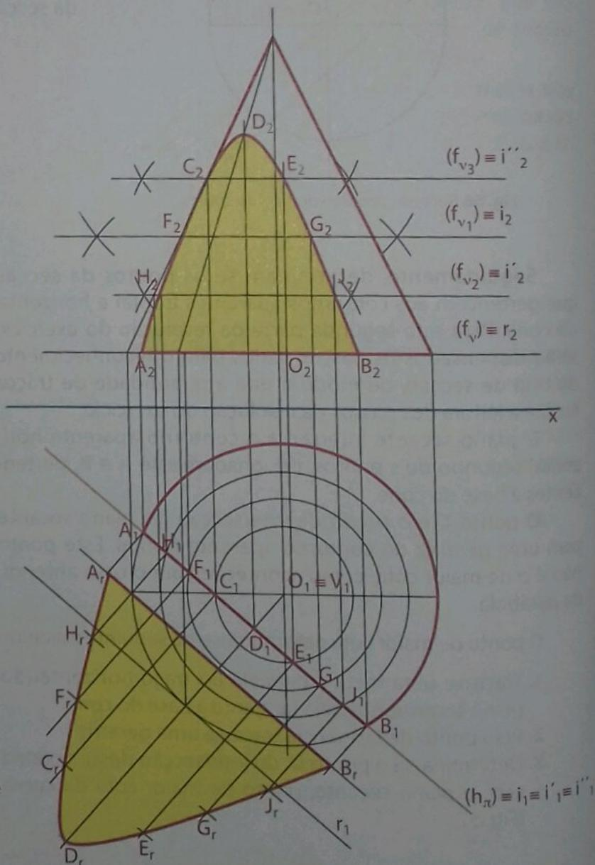
Fig. 58 Secção no cone de revolução e sua V. G.
